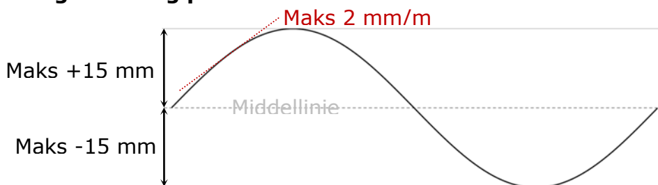
Figur 2.1 Krav til sporskifte byggebeddings jævnhed
