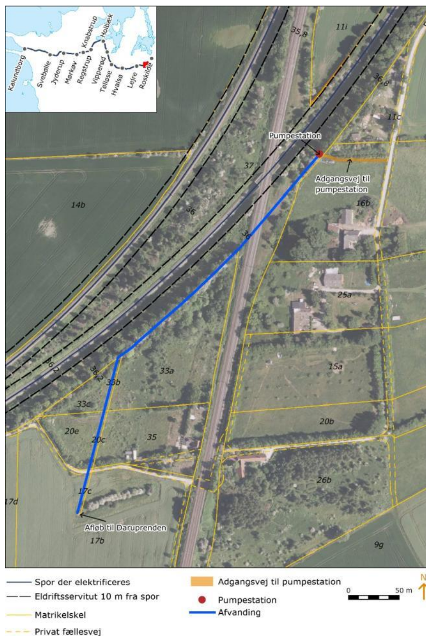
Figur 2-20 Pumpestation og afvanding til Daruprenden fra sporudfletningsbroen
