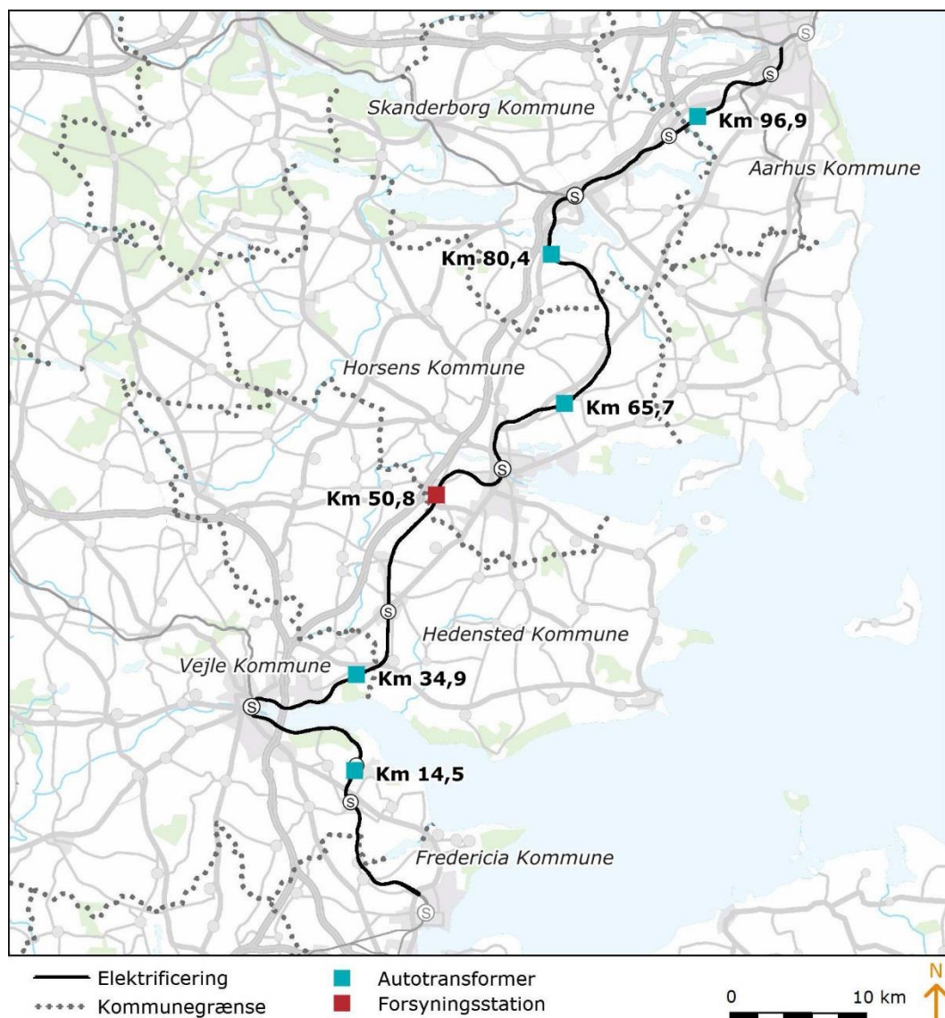
Figur 3: Forsyningsstation og autotransformere på strækningen Fredericia-Aarhus.
