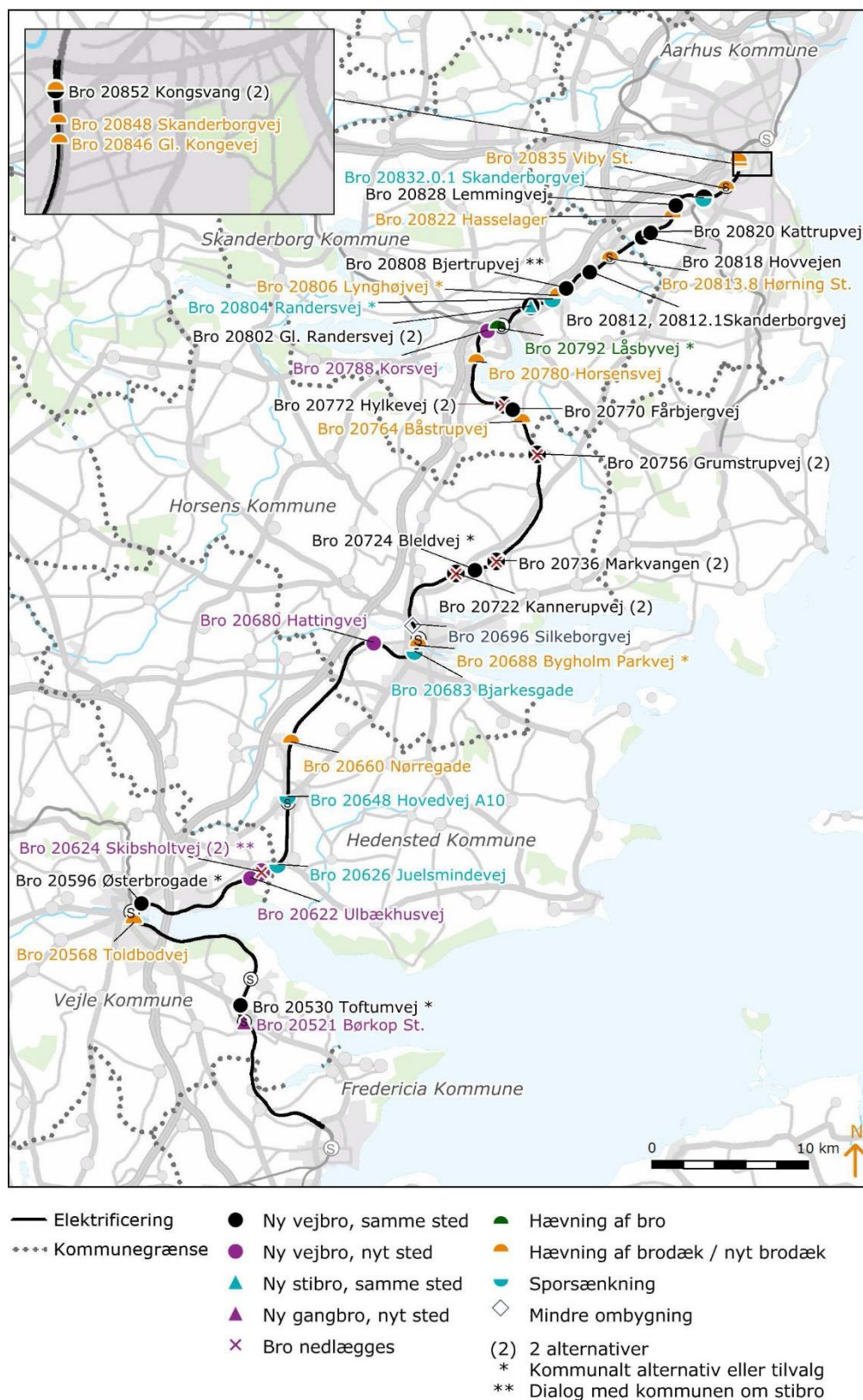
Figur 2: Oversigt over ændringer omkring broer ved elektrificeringen af Fredericia-Aarhus.
