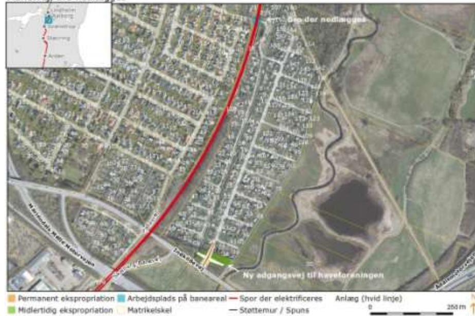
Planetvej, bro nedlægges
