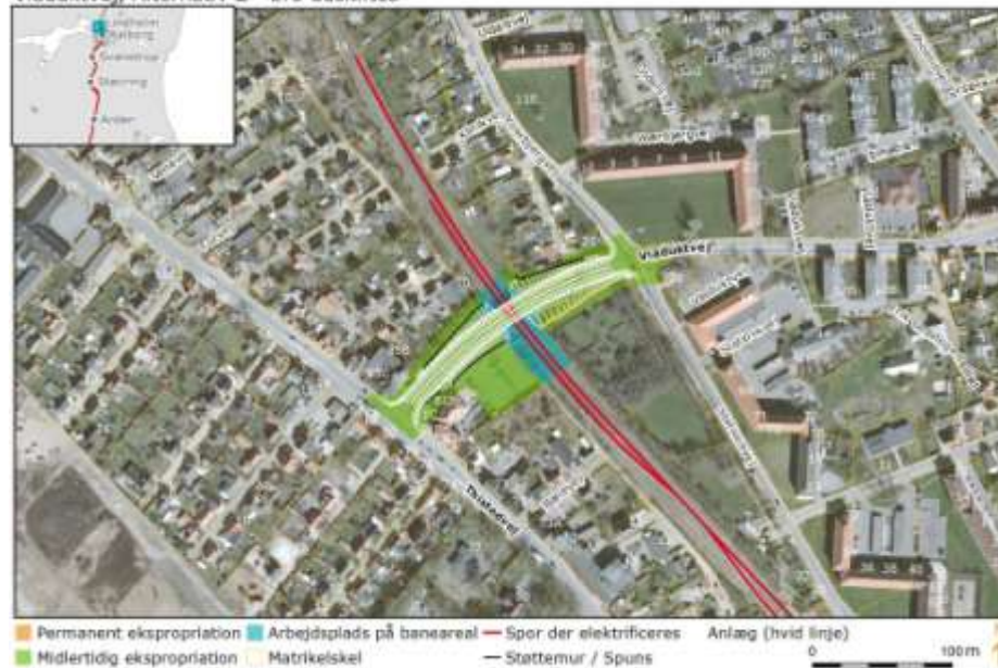
Viaduktvej, Alternativ 2 - bro udskiftes
