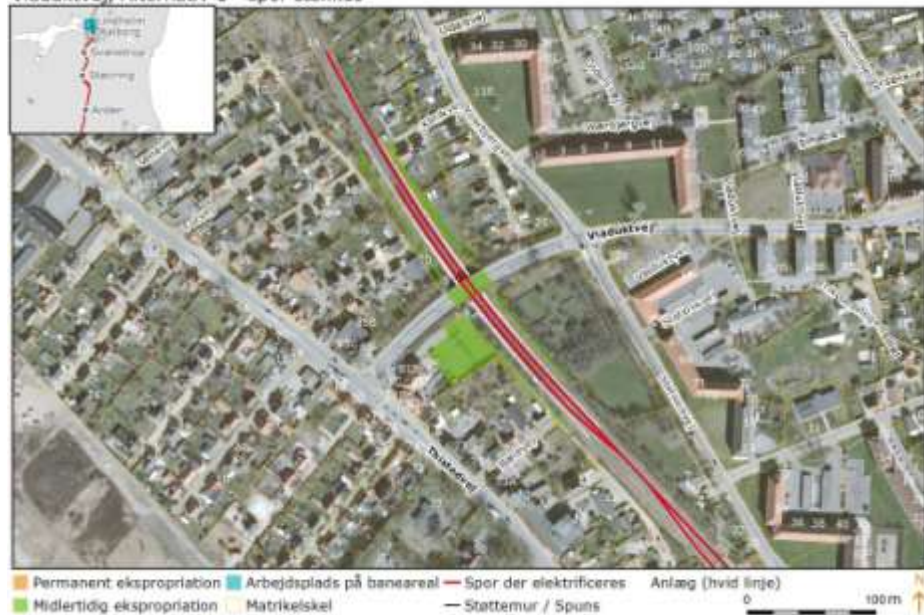
Viaduktvej, Alternativ 1 - spor sænkes
