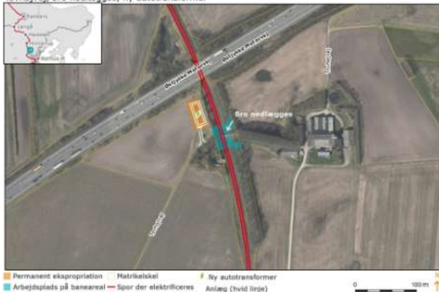
Tovhøjvej, bro nedlægges, ny autotransformer
