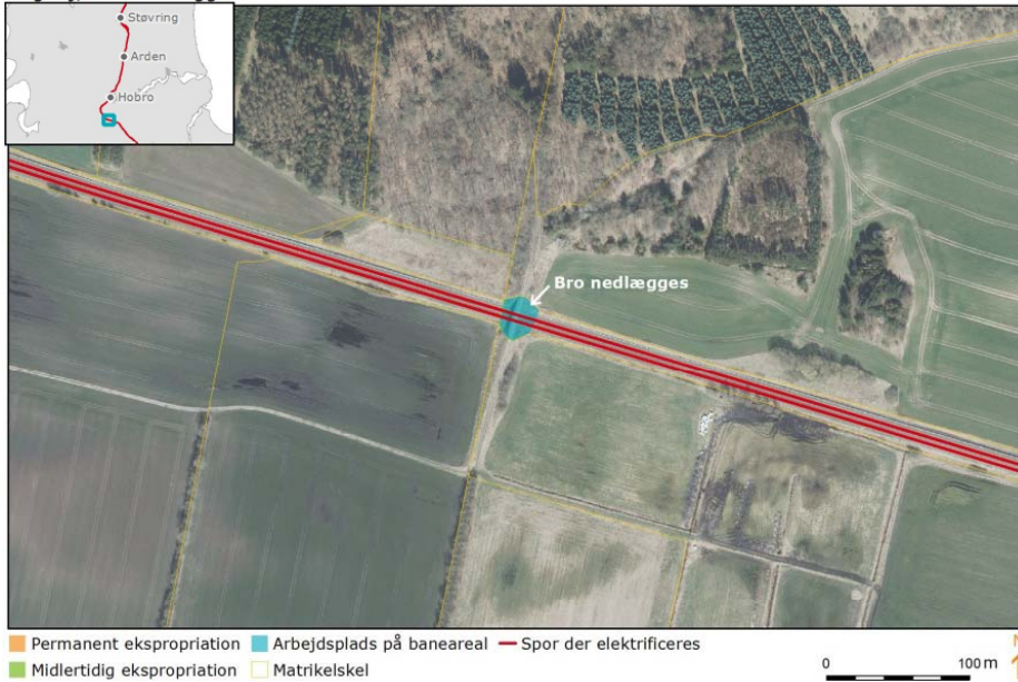
Engvej, bro nedlægges
