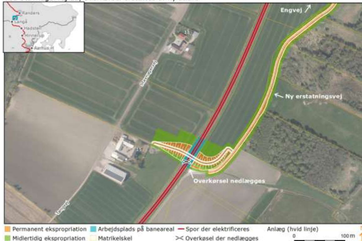
Ved Stavnagervej 15, overkørsel erstattes af ny stibro
