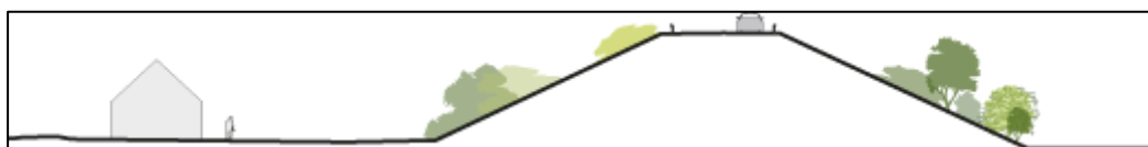
Figur 72. Snit gennem Vejdæmningen ved Tingshøjvej 111, set mod nord.
