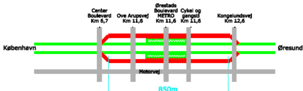
Figur 31 - Skematisk sporplan, Tilvalg 2
