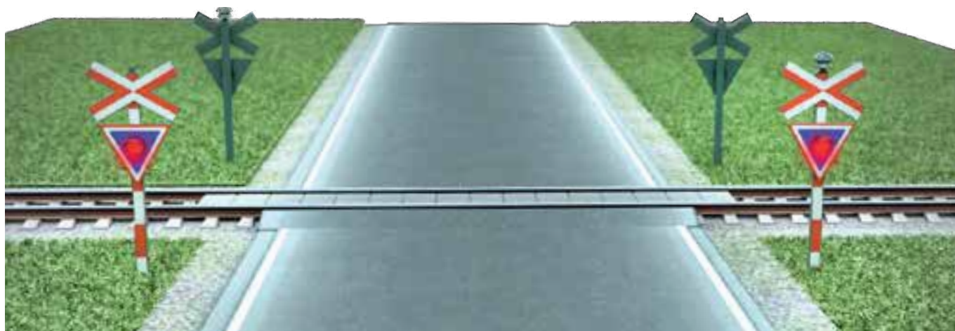
Figur 39. Advarselssignalanlæg, som kun har blinklys og klokker.
