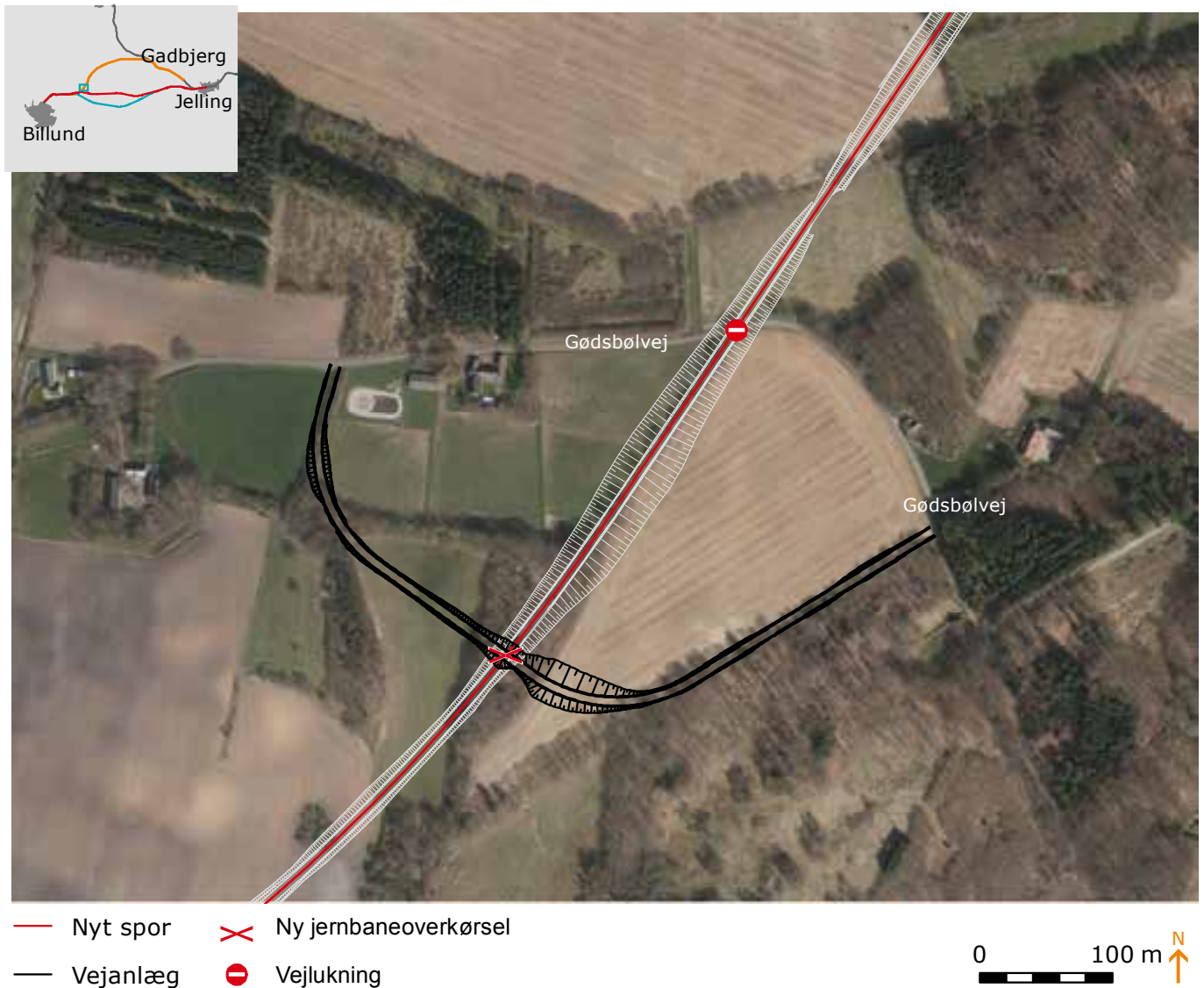
Figur 22. Omlægningen af Gødsbølvej.
