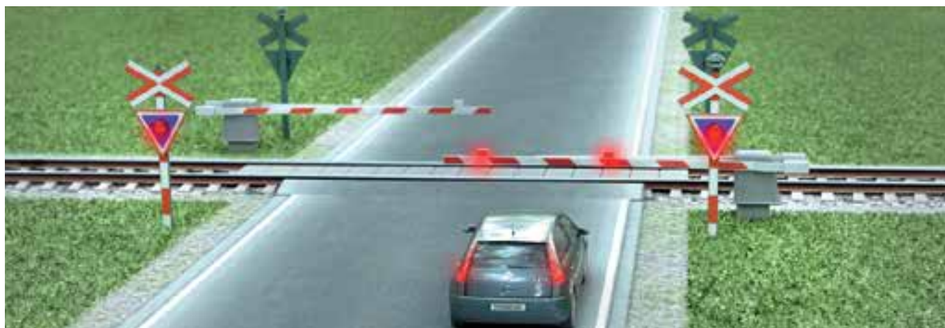
Figur 40. Halvbomanlæg, som har en bom på hver side af banen, der spærrer hver sin vejbane.
