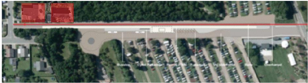
Figur 7. Station syd for Nordmarksvej, 288 meter lang perron. De to ejendomme, der må eksproprieres ved denne løsning, er markeret med rødt.
