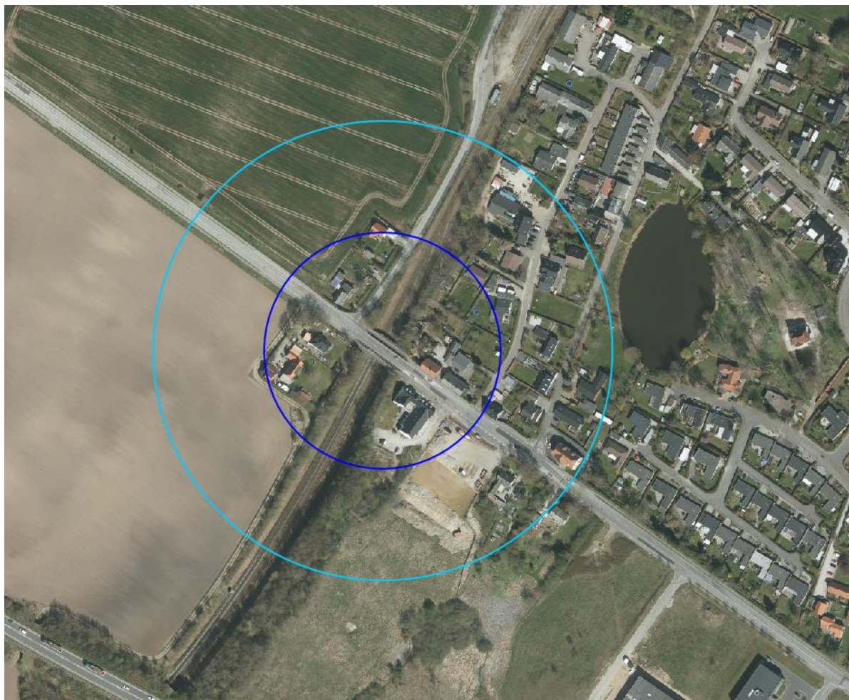
Figur 2 Grænseværdiafstande til 70 dB ved særligt støjende arbejder ved bro 20924 Gammel Viborgvej. Blå cirkel markerer afstanden ved nedrivning og lys blå cirkel markerer afstanden ved ramning af spuns.
