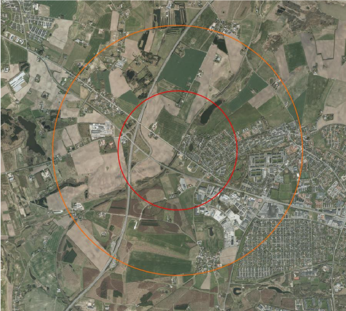
Figur 3 Grænseværdiafstande til 40 dB ved særligt støjende arbejder ved bro 20924 Gammel Viborgvej. Rød cirkel markerer afstanden ved nedrivning og orange cirkel markerer afstanden ved ramning.
