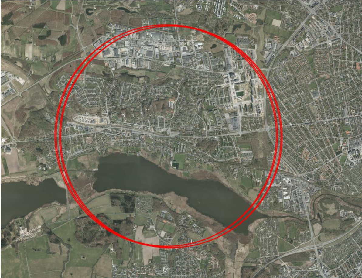
Figur 6 Grænseværdiafstande til 40 dB ved særligt støjende arbejder som ramning af spuns ved fløje og for sporafstivning. Markeret med røde cirkler.
