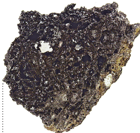
Leca-flage set i mikroskop (250 x forstørrelse)
