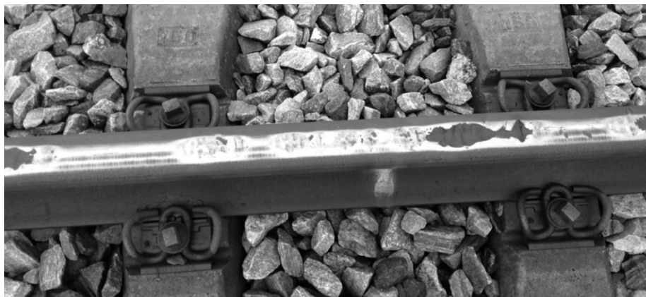
Figur 107 – Skinnepletter (squats) med afskalning
