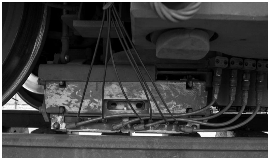
Figur 122 – Ultralyds-måleinstrument monteret på målevogn med slanger til påføring af kontaktmiddel (vand)
