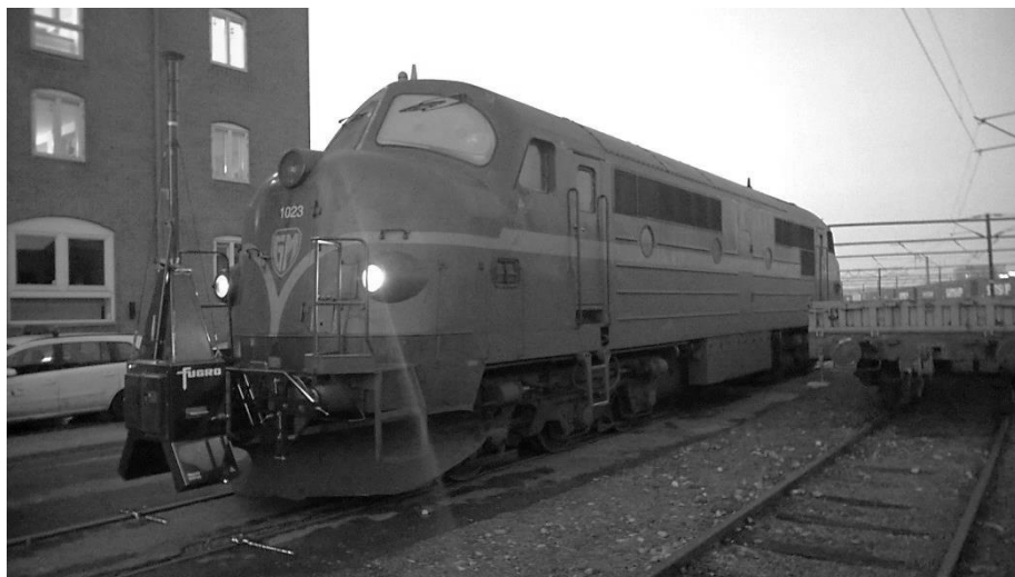
Figur 353 –Instrument til ubelastet måling monteret på MY-lokomotiv
