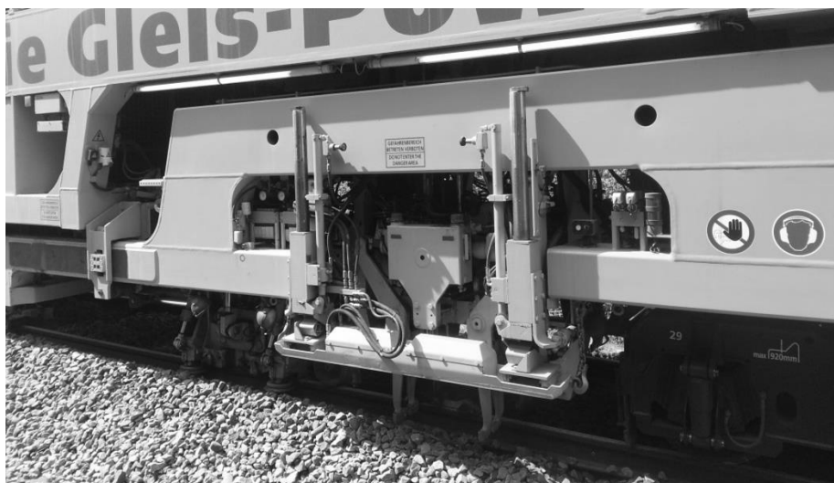
Figur 57 – Indbygget sporjustering til arbejdsjustering (se også afsnit 14.6.2 på side 291)
