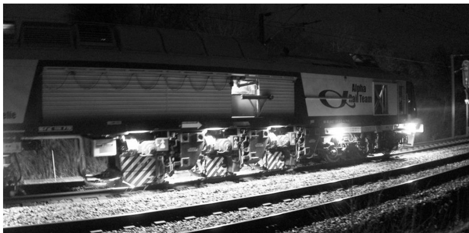
Figur 130 – Skinnefræsere med to fræsehjul og et slibehjul (til hver skinnestreg) i drift
