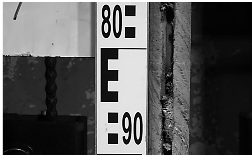
Figur 61 – Laggrænsen mellem skærver og sandfyld er her vurderet til 0,82 m fra SO
