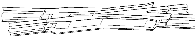
Figur 252 – Manganstål-krydsning med svejsbare ben
