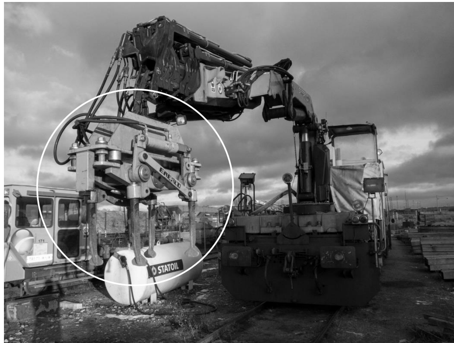
Figur 356 – "Edderkop" monteret på rendegraver til mindre sporjusteringsopgaver
