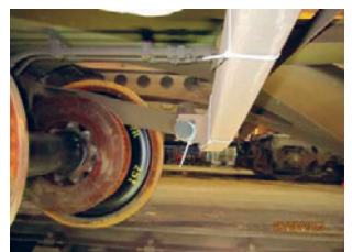
STØJMÅLING. En godsvogn udstyres med mikrofoner til at måle støjen fra skinnerne. Mikrofonens vindhætte ses som en grå cirkel i centrum af billedet. Foto: Bane Danmark
