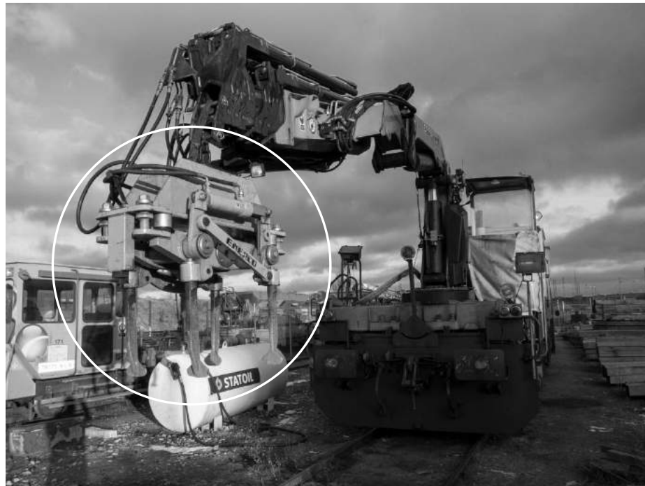
Figur 356 – "Edderkop" monteret på rendegraver til mindre sporjusteringsopgaver
