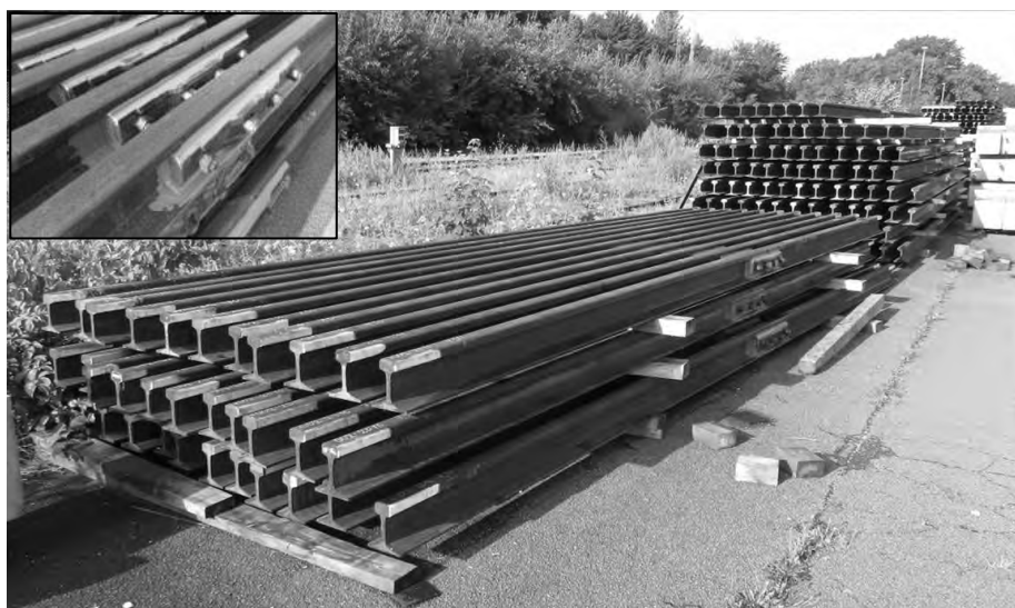
Figur 224 – Præfabrikerede skrå isolerklæbestød
