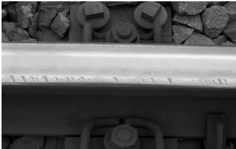
Figur 110 – Kørekantsrevner (head checks)
