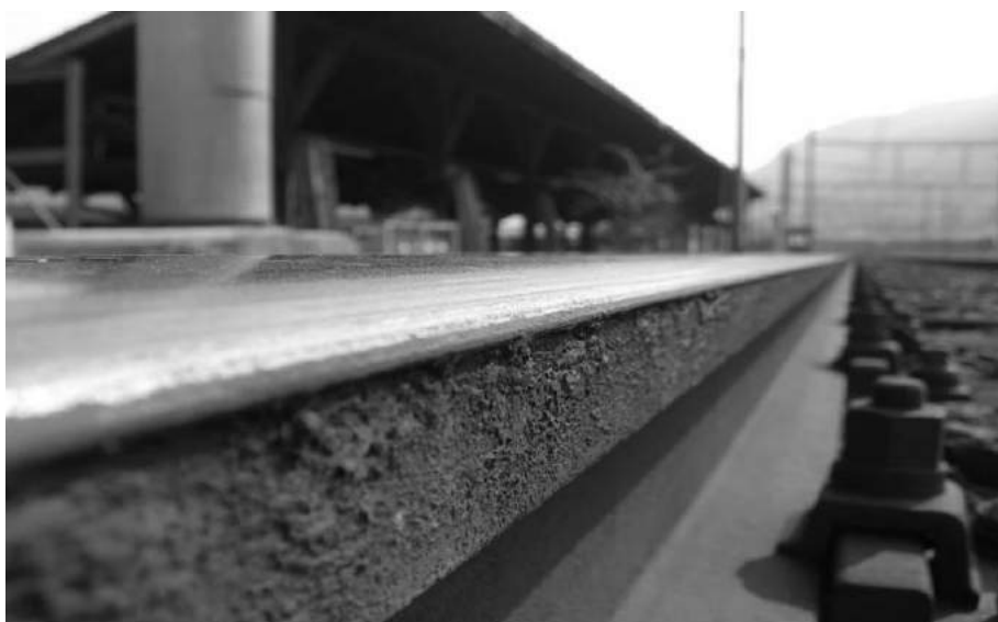
Figur 337 – Snæver sporvidde pga. "skæg" (udpresset skin- nehoved)
