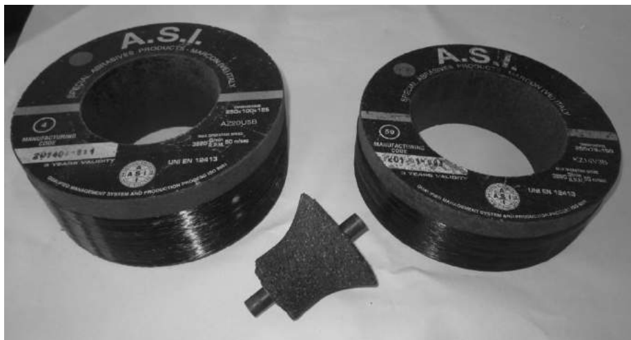
Figur 124 – Forskellige slibesten til roterende slibning samt højhastighedsslibning
