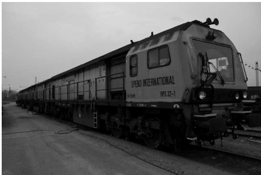
Figur 125 – Slibetog, Speno RPS-32, med 32 roterende slibesten
