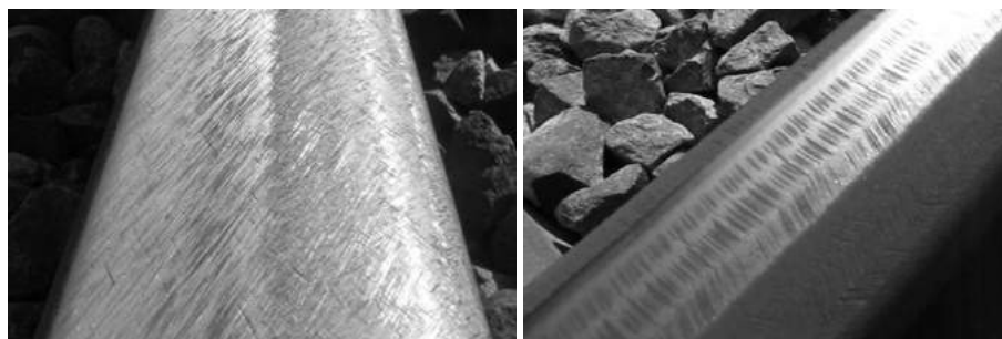
Figur 128 – Slibemærker fra hhv. højhastighedsslibning (tv) og konventionel slibning (th)
