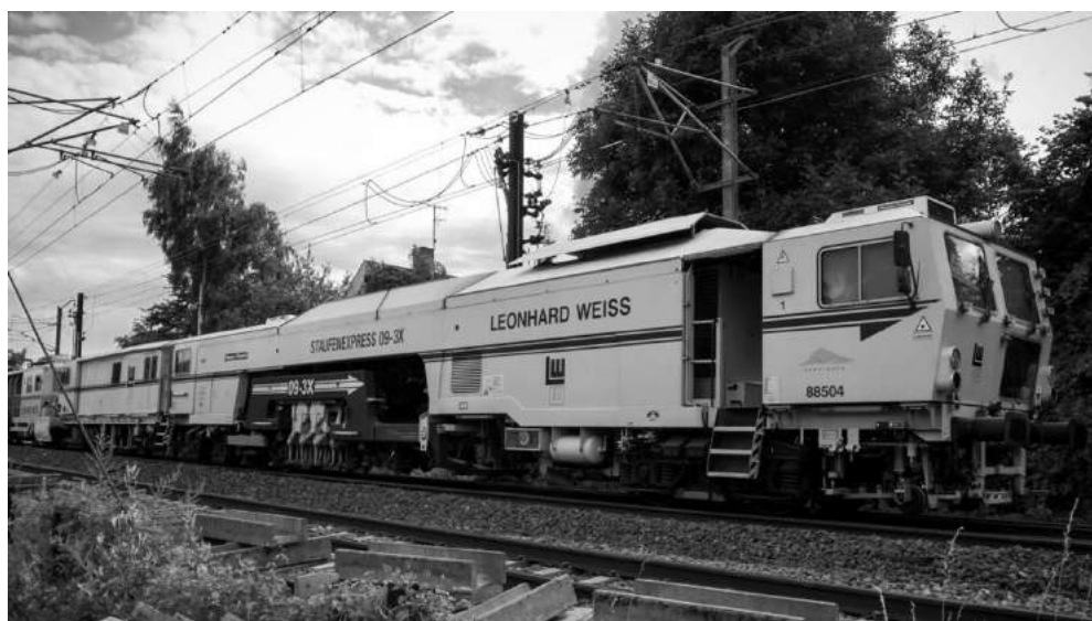
Figur 361 – Stræknings- justerings-maskine med satellit
