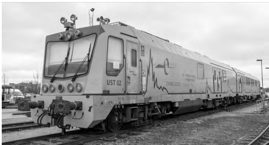
Figur 121 – Ultralyds- og hvirvelstrømsmåletog, Eurail-scout UST02
