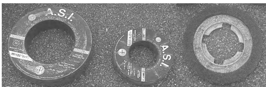
Figur 127 – Sporskifte-slibesten (mf+th) sammenlignet med strækningsslibesten (tv)
