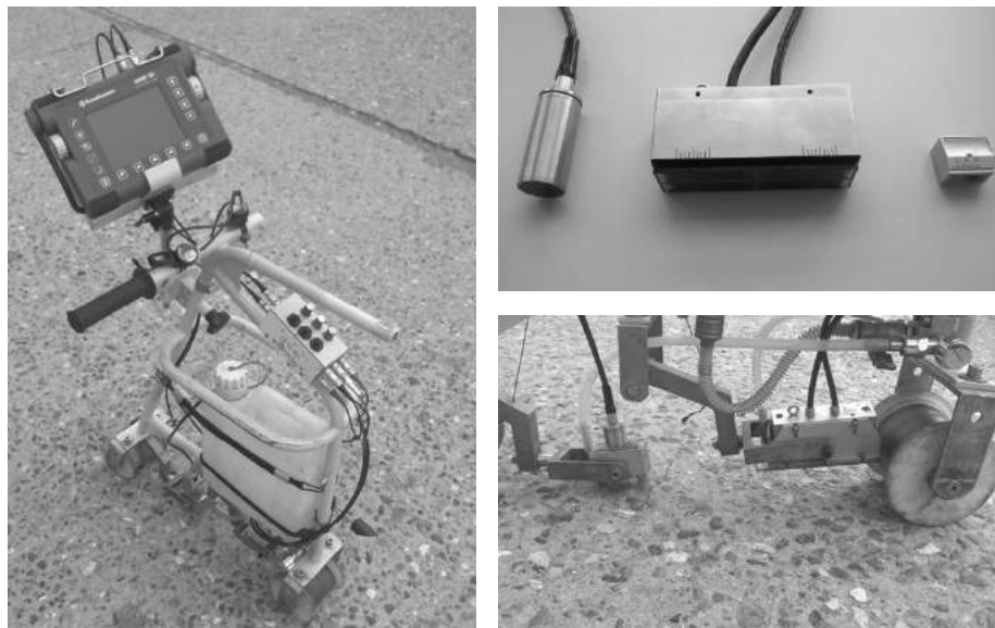
Figur 123 – Manuelt ultralyds-måleudstyr samt ultralydshoved og detalje af den del der har kontakt med skinnen
