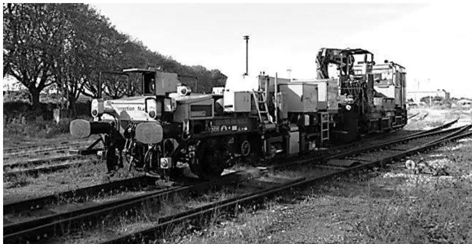
Figur 341 – Sporskifte-målevogn trukket af en trolje
