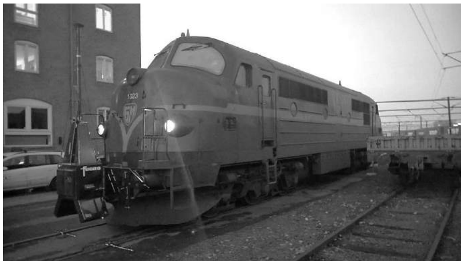
Figur 353 –Instrument til ubelastet måling monteret på MY-lokomotiv
