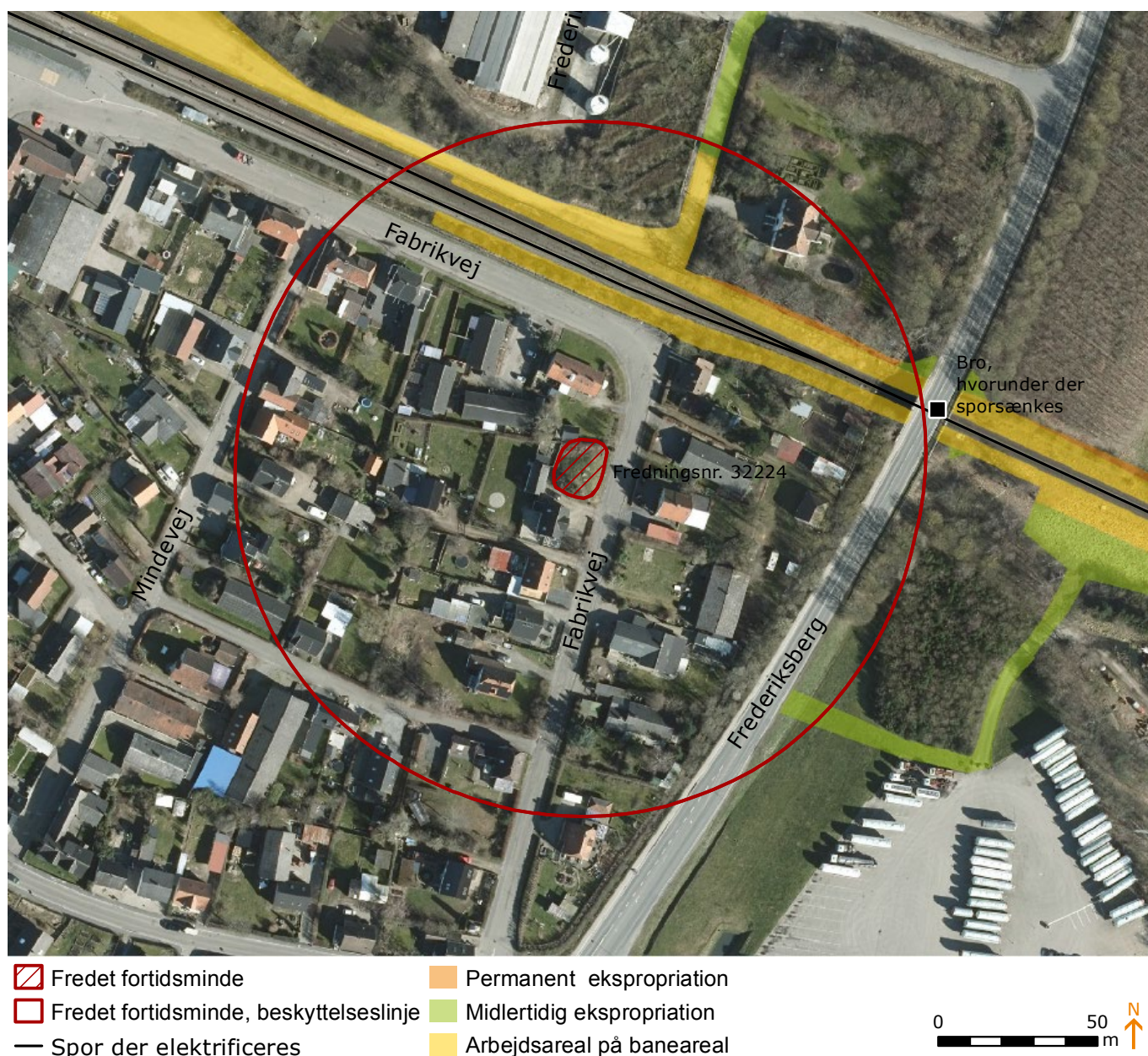
Figur 15 Køreledningsanlægget sættes op inden for den beskyttelseslinje, der er omkring en dysse fra stenalderen i Svebølle
