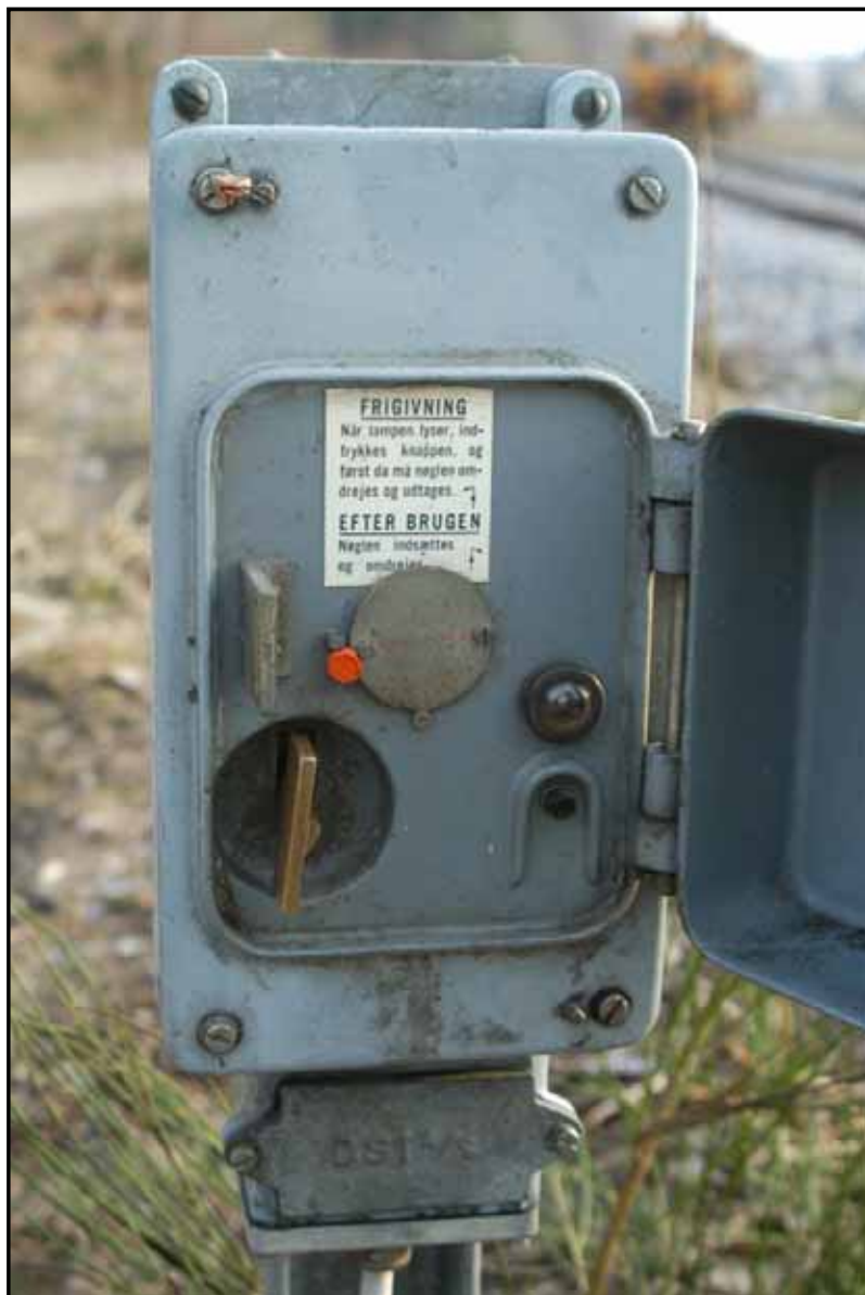
Skab med hovednøgle til elektromagnetisk nøgleflåst sporskifte
