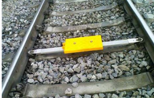
Eksempel på balise og vortok bar fastgjort af eksisterende skinnebefæstelse
